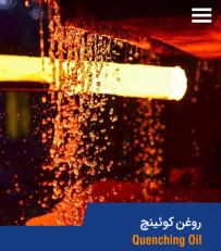
روغن کوئینچ با FLASHPOINT بالا و Vicosity Index تعریف شــــده، باعث كامل شدن عمليات سخت كارى مى شود.
